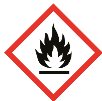
Flammable Entzündbar Inflammable
